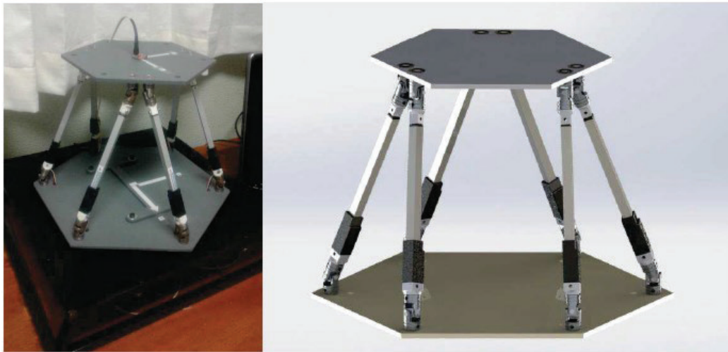
Figura 3. Prototipo de robot paralelo de 6 grados de libertad UPUR.
