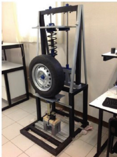
Figura 4. Plataforma experimental de una suspensión semi-activa con amortiguador magneto-reológico.
